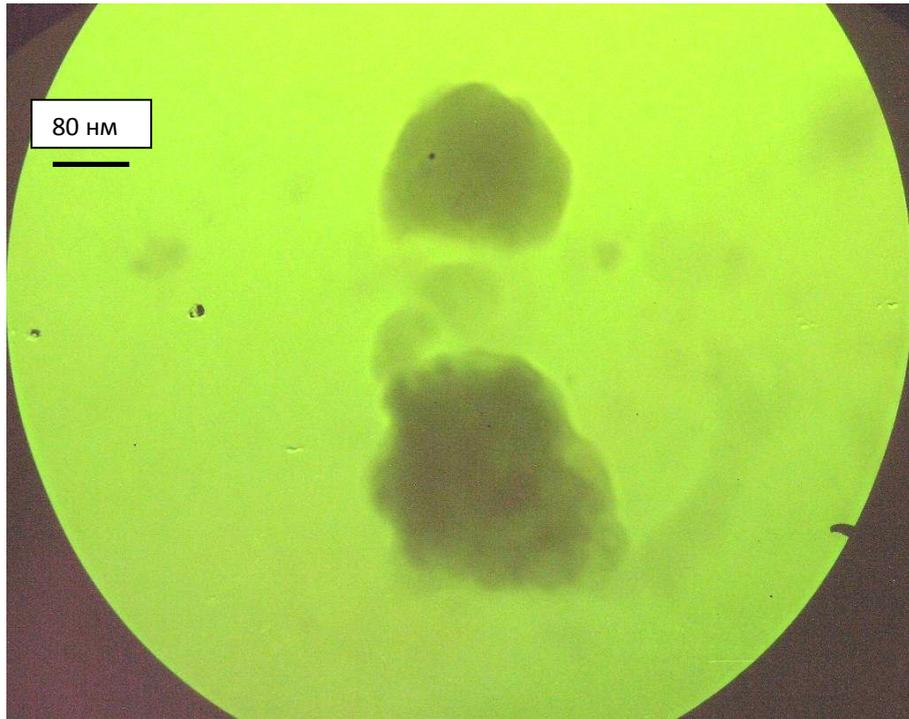
Рис. 2.1.4 Изображение катализатора КГЦ (увеличение 115000), полученное методом просвечивающей микроскопии.
